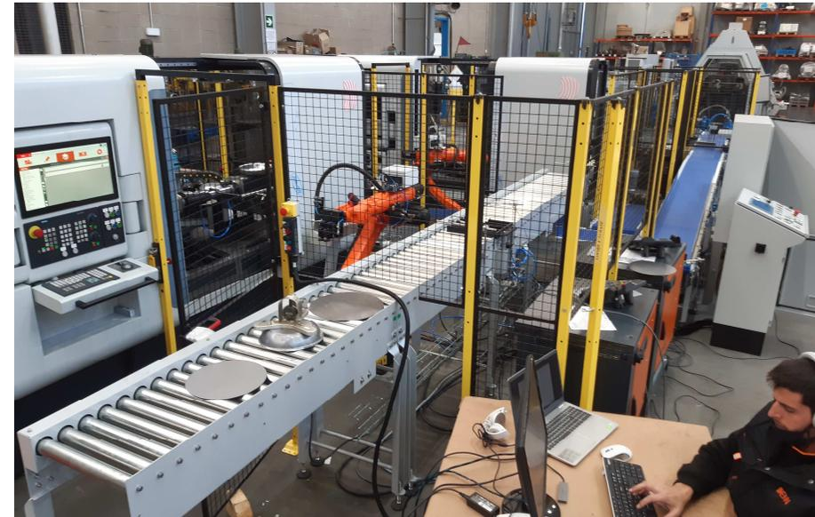
Uma célula automática de várias máquinas, com tornos de repuxo e outras máquinas auxiliares, e robotizadas, está atualmente em sua última fase de fabricação e, em breve, entrará na fase de "tryout". O objetivo desta linha com o mínimo de assistência dos operadores é produzir as painéis acabados com uma taxa de produção muito alta, mas também com o uso dos mais recentes avanços tecnológicos da "Indústria 4.0".
