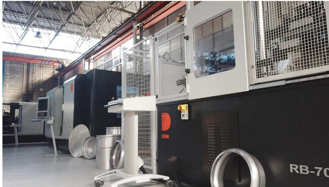
Esta linha de duas máquinas, um torno de repuxo mais uma máquina auxiliar para operações de flange foi homologada e já entregue ao cliente. Peças de altíssima tecnologia utilizadas na área de redes de transmissão de energia elétrica, e com tolerâncias de fabricação muito rígidas, também foram verificadas e validadas pelo cliente que, por sua vez, parabenizou a equipe técnica da DENN pelo seu trabalho.
